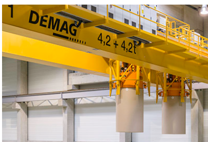
41540-92 (li) : und 41540-123 (re) Zwei Demag Prozesskrane mit jeweils zwei unabhängig voneinander verfahrbaren Hubwerken sorgen bei Blue Paper für einen schnellen Umschlag der Papierrollen.
