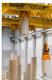
41540-92 (li) : und 41540-123 (re) Zwei Demag Prozesskrane mit jeweils zwei unabhängig voneinander verfahrbaren Hubwerken sorgen bei Blue Paper für einen schnellen Umschlag der Papierrollen.
