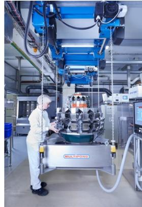
41211: Konstruktiver Aufbau des Demag Quadro Kettenzug LDC-Q mit vier Lasthaken
