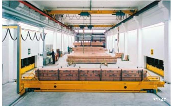
Die Last – millimetergenau positioniert – kann durch die Wandöffnungen weitergeführt werden.
