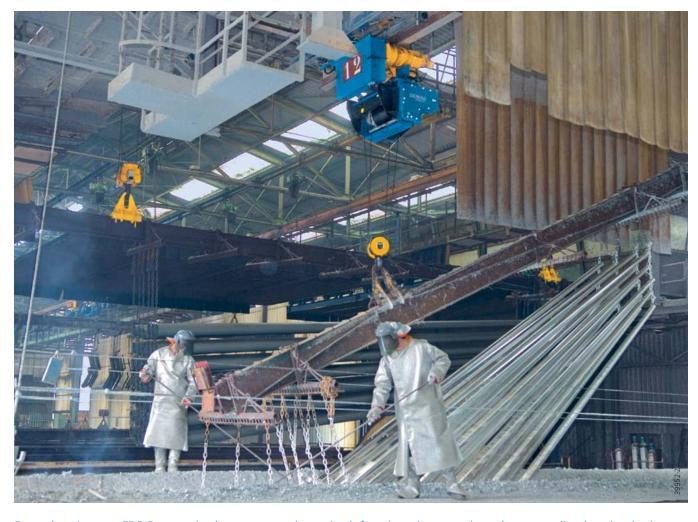
Des palans à pattes FDR Demag circulent sur une voie en circuit fermé semi-automatique dans un atelier de galvanisation.
