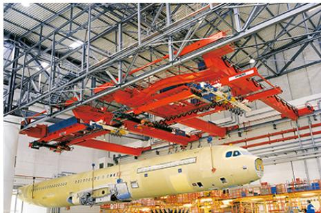
Demag Prozesskran in der Fertigungsendlinie bei Airbus in Hamburg-Finkenwerder
