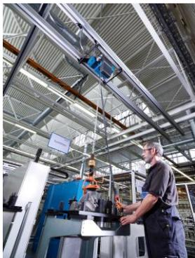
**Bild 40665-7:** Beispiel für den Einsatz eines Leichtkransystems mit Manulift DCM-Pro in der Automobilindustrie
