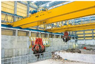
40000-22: Demag Prozesskrane übernehmen die Einlagerung, den Brennstoff-Mix sowie die Versorgung der Ofenlinien.
