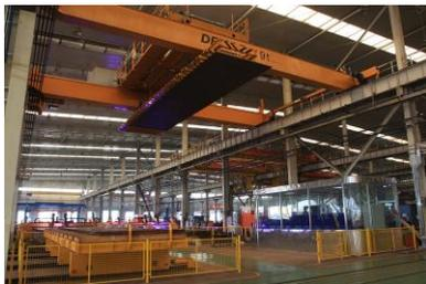
**Bild 41012-22:** Der Demag Prozesskran mit Magnettraverse transportiert die Bleche und nimmt nach deren Bearbeitung die kompletten Brennbilder auf.
