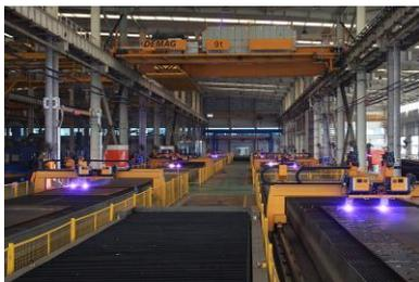
**Bild 41012-24:** 6 Brennschneidmaschinen in zwei parallelen Reihen: Der Logistik mit Prozesskran stellt die Funktion der Anlagen im 24/7-Betrieb sicher.
