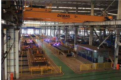
**Bild 41012-1:** Voll automatisierte Prozesslösung zur Bearbeitung von Blechen mit sechs Brenntischen und einem Prozesskran.
