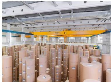
Links: **40240-35**: Bis zu vier Rollen gleichzeitig mit einem Hub: Demag Prozesskran mit mechanischem Greifer
