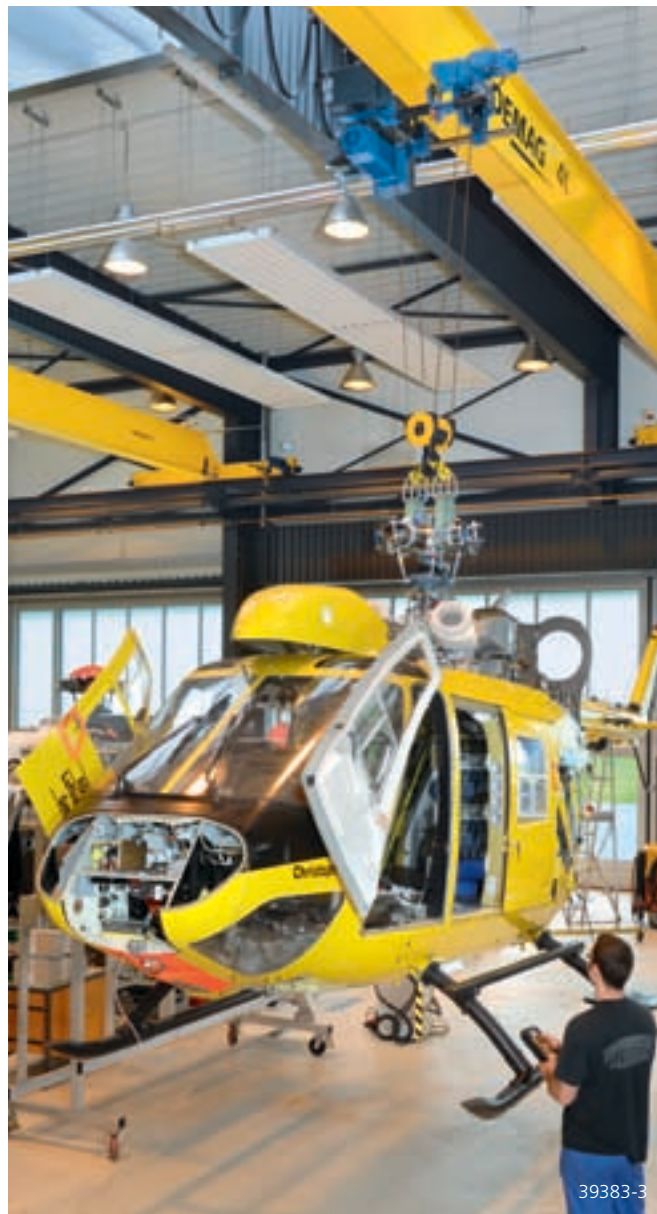
Wciągnik Demag przenosi helikopter na stanowisko konserwacji
