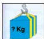
Controllare il peso del carico. Non sovraccaricare i tiranti.
