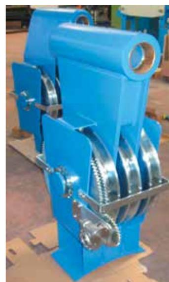
Particolare del bozzello con sistema frenante realizzato con riduttore calettato su pignone e corona solidale a puleggia
