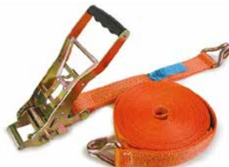
**Cod. RER - ERGONOMICO Serie 50 mm. 5 Ton.:** Tenditore in acciaio zincato anticorrosione. Nastro in poliester 100% alta tenacità. Tensione del nastro con azionamento della leva verso il basso.
