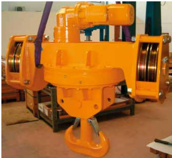
Bilancino motorizzato con ralla e motoriduttore 20t - M6 4 pulegge
