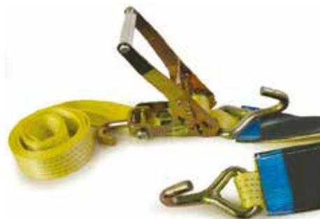
**Cod. RHLB-BISARCA Serie 35 mm. 3 Ton.:** Tenditore in acciaio zincato anticorrosione. Nastro in poliester 100 % alta tenacità. Tensione del nastro con azionamento della leva verso l'alto, con 3 ganci uncino a un dito, 3 tasselli in plastica o 1 protezione in gomma da mm 500.
